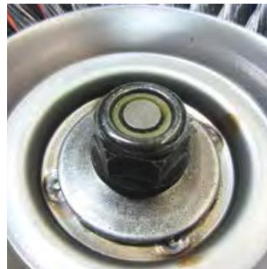
Richtiges Spannen der Bürste in die Motorsense
